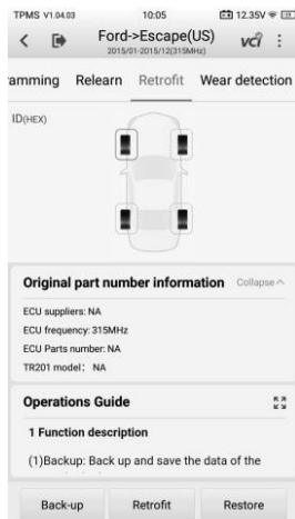
Rysunek 5-1 Przykładowy ekran modernizacji TPMS
